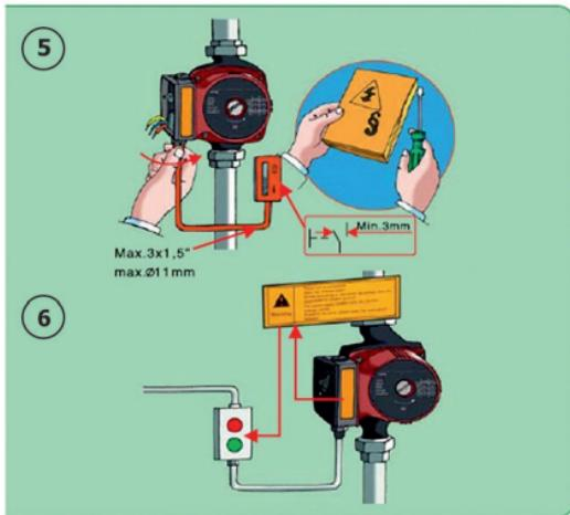
Перед подключением сравните параметры электросети с данными, указанными на табличке насоса. Насос должен быть заземлен в соответствии с местными правилами.
